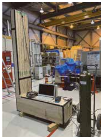
写真1 間仕切壁内気流の実験
