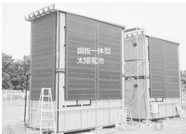
写真1 実験棟および太陽電池の設置状況
