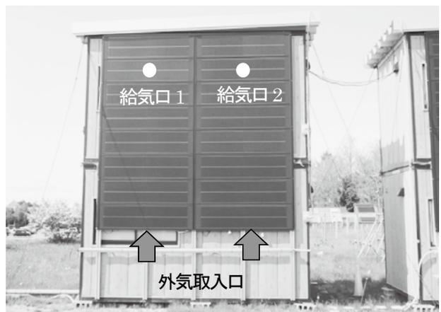
写真3 給気口および外気取入口
