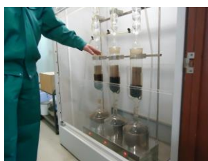
アスファルト抽出試験
